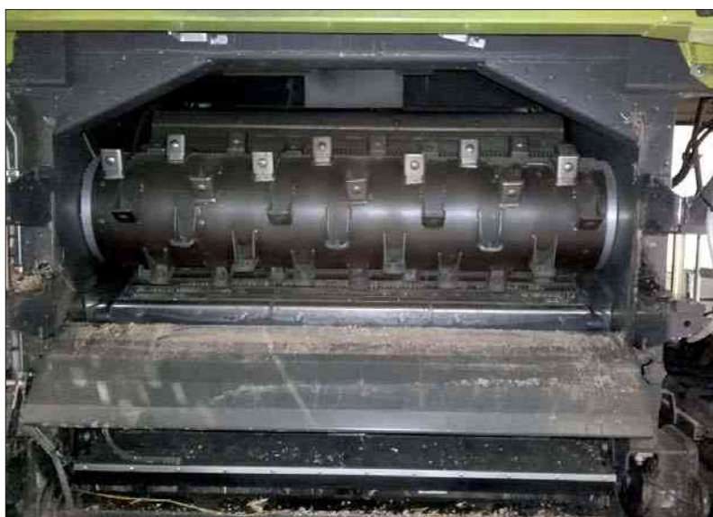
Fot. 6. W wielobębnowym zespole młocącym wstępny bęben przyspieszający wyposażony jest w gładkie łopatki i umieszczony jest bezpośrednio przed bębniem młocącym (fot. K. Krzyżaniak)
