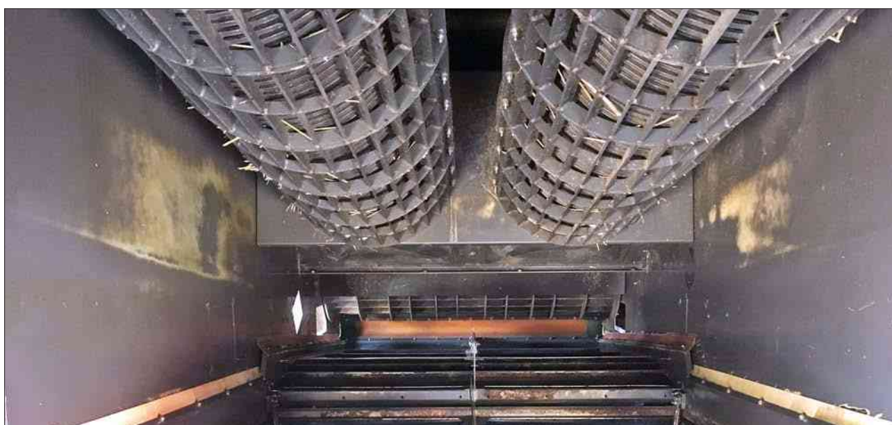
Fot. 9. Kombajny hybrydowe mają wielobębnowy zespół omłotowy o stycznym zasilaniu oraz separatory rotorowe o osiowym przepływie masy (fot. K. Krzyżaniak)
