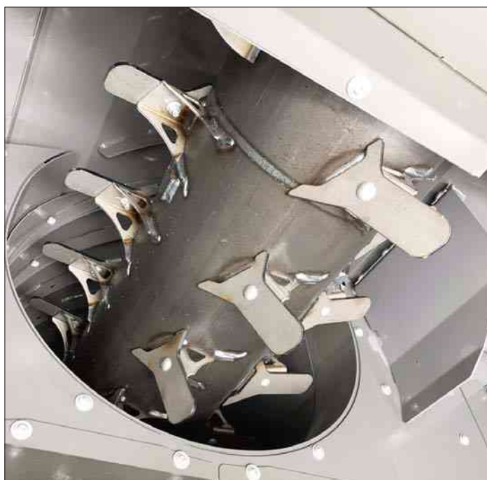
Fot. 5. W sekcji separującej stosuje się rozmieszczone śrubowo łopatki wydzielające (fot. K. Krzyżaniak)
