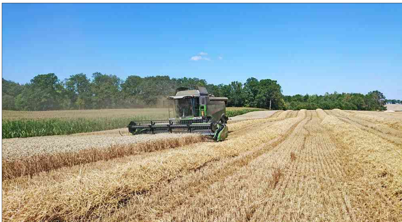
Fot. 7. Dobrze uformowane wały słomy po zbiorze kombajnem z wytrząsaczem klawiszowym (fot. Krzyżaniak)
