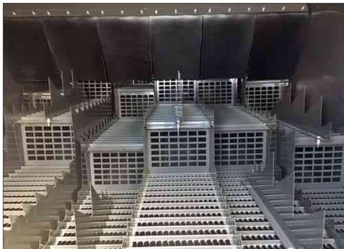
Fot. 3. Dodatkowe segmenty zębowe montuje się na kaskadach wytrząsacza w celu rozluźnienia masy zbożowej (fot. K. Krzyżaniak)
